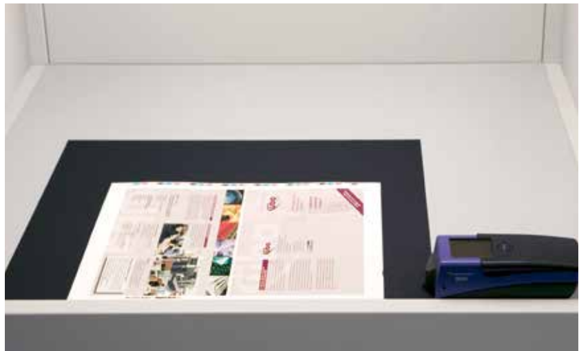
Abbildung A-14: In vielen Messsystemen für den Auflagedruck ist eine schwarze Unterlage bereits integriert (Bild oben). Fehlt sie, kann beispielsweise schwarzer Fotokarton verwendet werden (unteres Bild).
