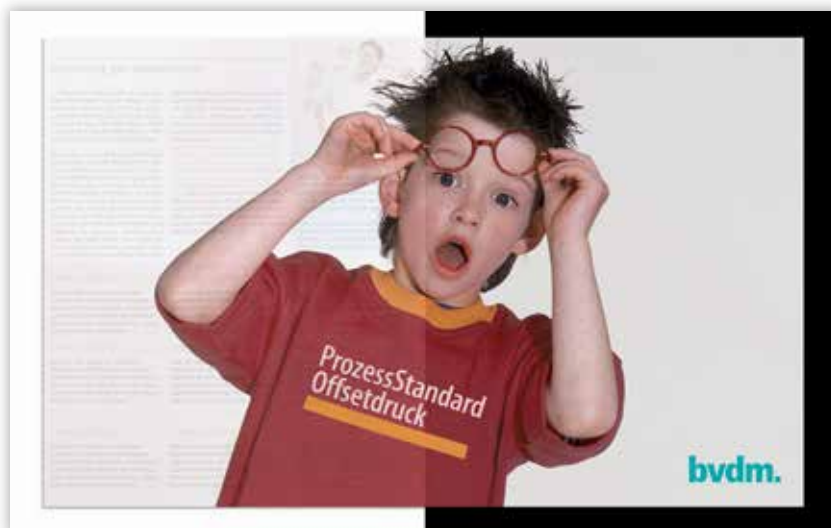
Abbildung A-12: Wirkungsweise der Unterlage: Bei weißer Unterlage scheint das rückseitig gedruckte Sujet durch und verändert lokal Betrachtungsergebnisse und Messwerte. Die schwarze Unterlage egalisiert den Rückseiteneinfluss.
