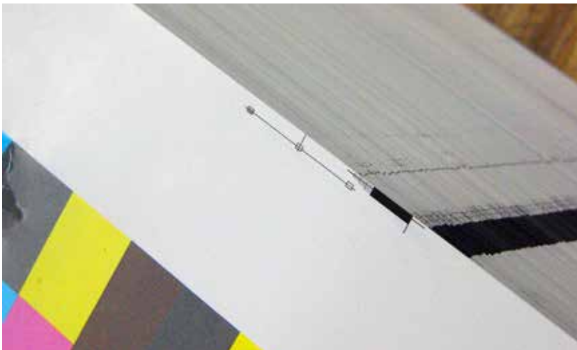
Abbildung A-77: Kontrollmittel wie Ziehmarken und Passkreuze werden unter dem Oberbegriff Kontrollmarken zusammengefasst.
