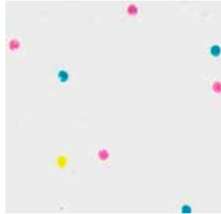
Abbildung B-13: Mikroaufnahme der Papierweißsimulation auf einem Prüfdruck
